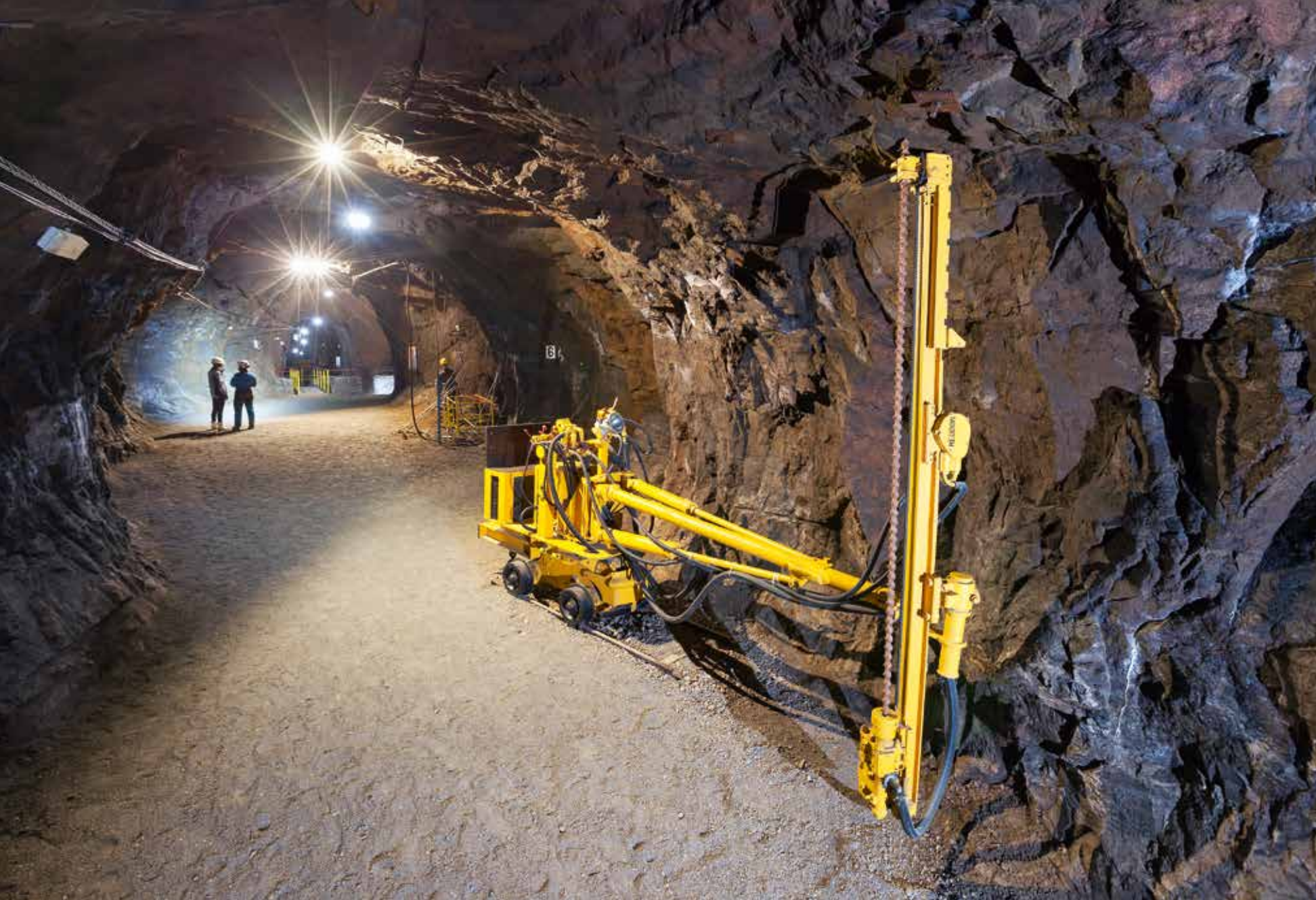
Dieser pressluftbetriebene Bohrwagen zum Setzen der Ankerbolzen war für den Einsatz auf Schienen gedacht. Er steht heute im Besucherstollen des Grubenmuseums in Rümelingen.
